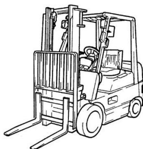
يمكن أن تعمل الرافعات الشوكية إما بالبطارية، وإما بالغاز المضغوط، وإما بوقود дизل/البنزين، بناءً على طريقة صناعتها. تُصمم الرافعات الشوكية بشكل عام إما ليتم استخدامها داخل المستودعات ذات الأسطح المستوية، وإما للاستخدام الخارجي في جميع المناطق.
