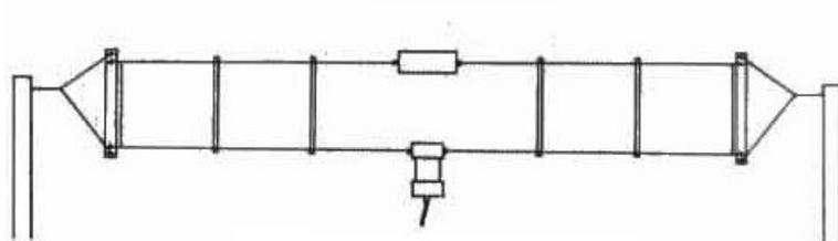
La antena dipolo de alta frecuencia puede ocupar bastante espacio en un recinto. La antena puede medir hasta 40-50 metros de aislante a aislante, aunque en realidad puede ser más larga si se tienen en cuenta los amarres y los anclajes. Las antenas de alta frecuencia también
