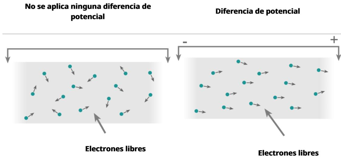
Cuando se conecta una bombilla a un generador, una cierta cantidad de electrones pasa a través de los cables (filamentos) de la bombilla. Este flujo de electrones corresponde a la corriente o intensidad (I) y se mide en amperios (A).
