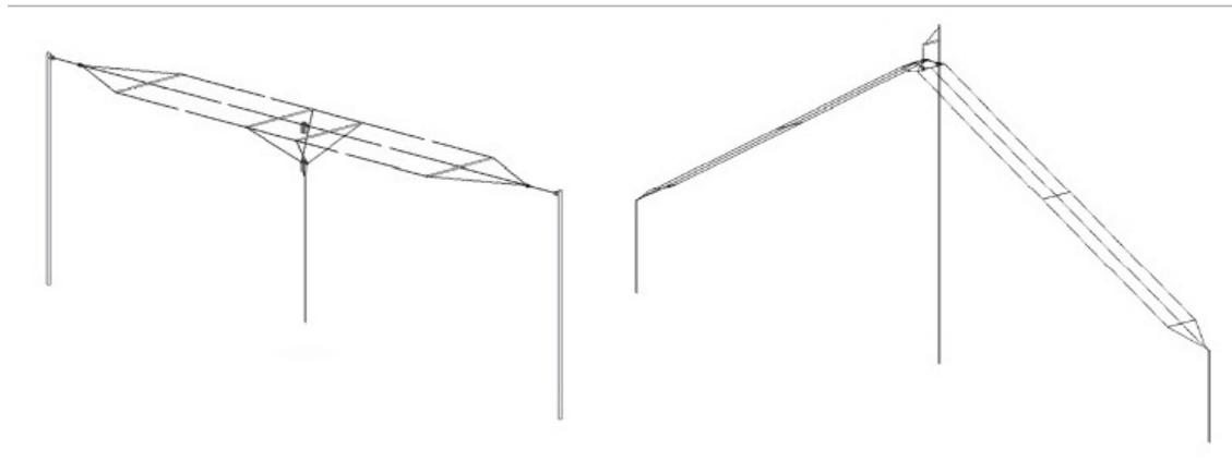
**Configuración horizontal** - La antena dipolo se tensa suspendida desde ambos extremos a la misma altura. El cable de conexión a la estación base queda suspendida, aunque lo ideal es fijarlo a algo cerca del nivel del suelo o anclarlo a un poste resistente para evitar que se mueva con el viento y quitar peso a la instalación. La configuración horizontal se considera la mejor opción, ya que llevará la señal lo más lejos posible.
