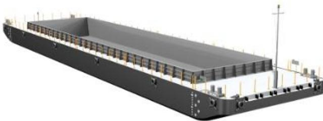
**Chalana-tanque** - Gabarra diseñada para transportar líquidos o gases comprimidos. Las chalanas-tanque requieren un mantenimiento especializado y sólo se utilizarán si los puertos
