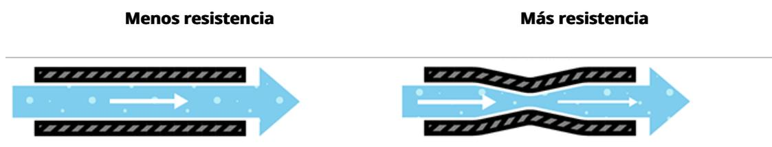
La resistencia (R) se expresa en ohmios. Ohm define la unidad de resistencia de "1 ohmio" como la resistencia entre dos puntos de un conductor donde la aplicación de 1 voltio empujará
