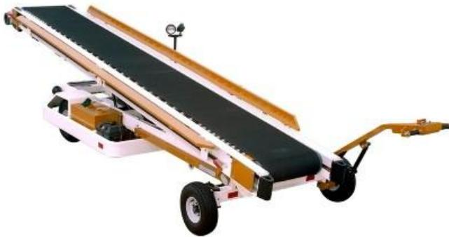
**Carro para dispositivos unitarios de carga y palés aéreos** - Carro destinado al transporte de dispositivos unitarios de carga y palés aéreos prefabricados. No funcionan por sí solos, y hay que tirar de ellos o empujarlos por la plataforma. Los rodillos ayudan a descargar y cargar, pero la carga debe empujarse físicamente, ya que no existe un proceso accionado mecánicamente.
