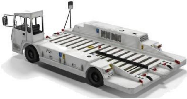
**Cinta transportadora** - Una cinta transportadora automatizada con altura ajustable que puede transportar artículos pequeños hasta puertas de fuselaje de cualquier tamaño. Las cintas transportadoras suelen utilizarse para equipajes, paquetes sueltos o artículos pequeños especiales. También pueden utilizarse para aeronaves demasiado pequeñas para aceptar un montacargas de gran altura.
