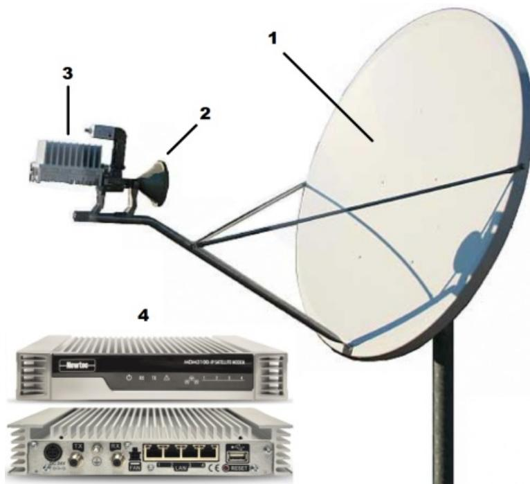
Los BUC, LNB y módems requieren algún tipo de alimentación externa, aunque suele ser
