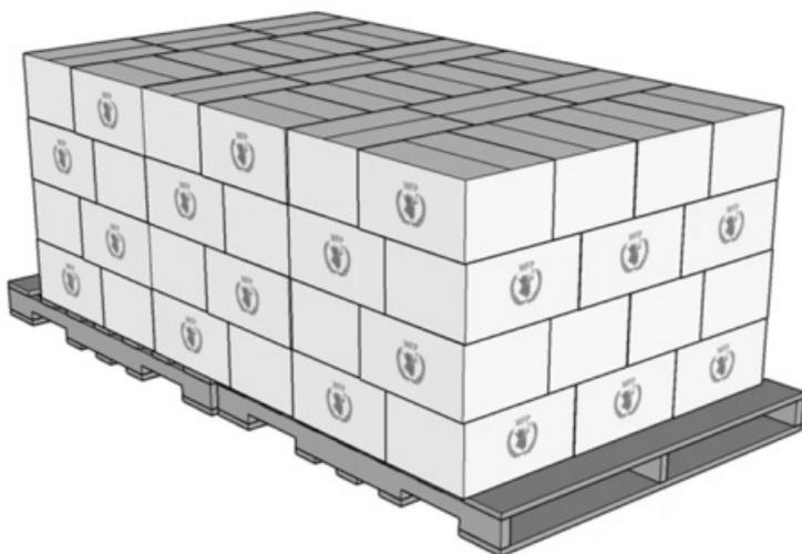
La carga apilada debe ser almacenada de la forma más segura posible. Los montones deben estar dispuestos en capas entrelazadas. Es mucho más probable que un montón no entrelazado se caiga y/o ejerza presión sobre la capa más baja de cajas de cartón. Las cajas parcialmente vacías no deben almacenarse en la parte inferior del montón para evitar que los niveles más bajos se hundan y provoquen el derrumbe del apilamiento.
