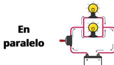
1. **Tensión:** La tensión es igual en todos los componentes de un circuito en paralelo.
