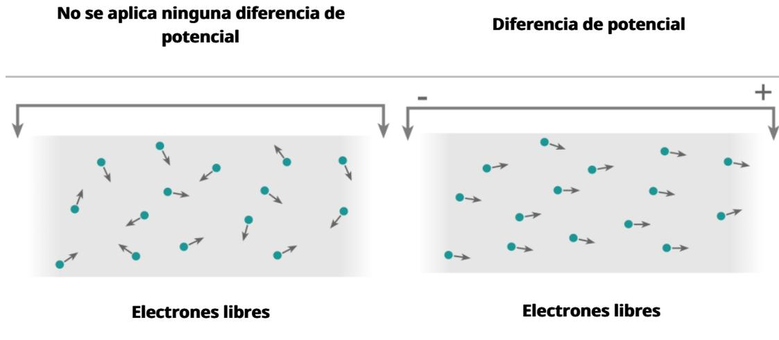
Cuando se conecta una bombilla a un generador, una cierta cantidad de electrones pasa a través de los cables (filamentos) de la bombilla. Este flujo de electrones corresponde a la corriente o intensidad (I) y se mide en amperios (A).
