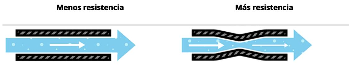
La resistencia (R) se expresa en ohmios. Ohm define la unidad de resistencia de "1 ohmio" como la resistencia entre dos puntos de un conductor donde la aplicación de 1 voltio empujará 1 amperio. Este valor se representa generalmente en diagramas y esquemas con la letra griega
