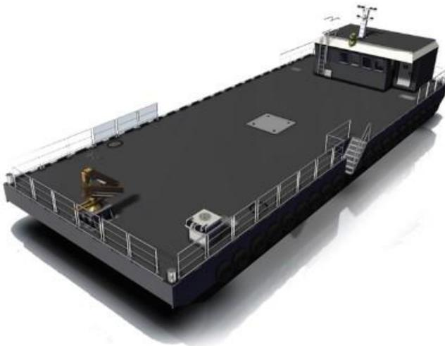
**Barcaça vulgar** – Uma barcaça vulgar é uma plataforma flutuante não autoalimentada, capaz de suportar a carga, mas sem direção nem motor. As barcaças vulgares exigem um barco externo para se mover, incluindo um barco de reboque ou um "empurrador", um barco separado motorizado, especificamente concebido para empurrar ou puxar barcaças vulgares ao longo das vias navegáveis.
