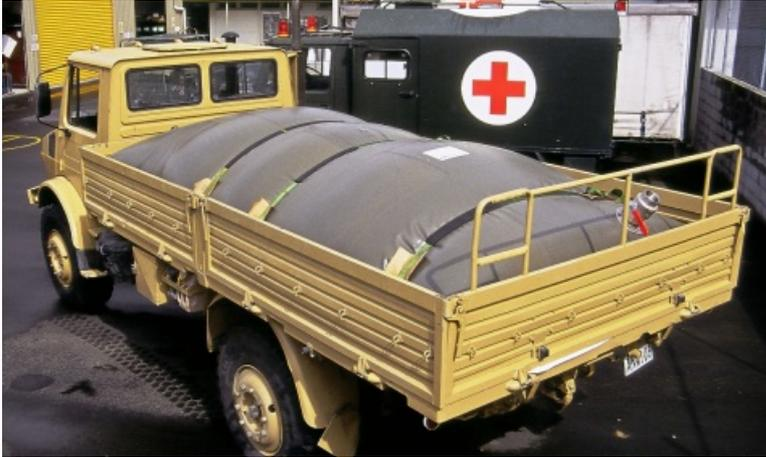
Os tanques dobráveis de combustível num veículo devem ser devidamente amarrados e fixados, tal como qualquer outra carga. As fixações devem acomodar o peso total do combustível, e o próprio tanque dobrável deve ser devidamente classificado para utilização como transporte móvel. Consultar o fabricante antes de utilizar um tanque dobrável para efeitos de transporte.
