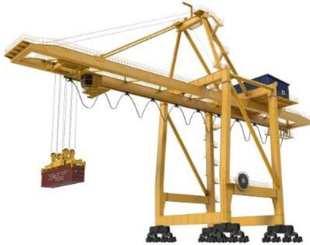
**Grua de pórtico** - Outra forma de grua de contentor móvel, uma que especificamente se move de ambos os lados de um navio ou de uma pilha. As gruas de pórtico podem ser suficientemente grandes para alcançar o convés de um navio inteiro, mas também podem ser utilizadas para carregar e descarregar camiões ou pilhas de carga.
