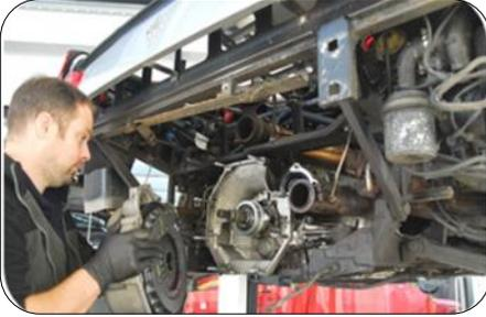
Ne manipulez pas les plaquettes de frein, les pièces d'embrayage ou les joints d'étanchéité sans équipement de protection, car ils peuvent contenir de l'amiante.
