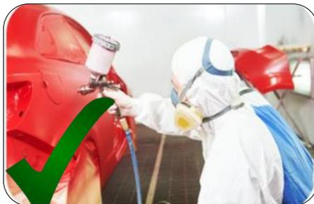
Utilisez l'équipement de protection individuelle approprié : Gants en PVC, bottes de sécurité, combinaison de protection avec capuchon et respirateur à adduction d'air pur.
