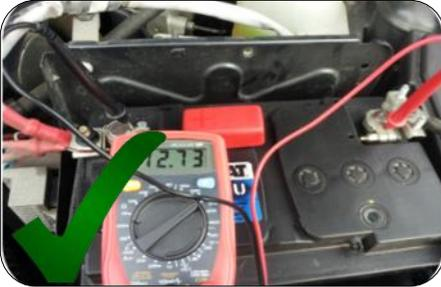
Assurez-vous que les batteries sont bien entretenues: nettoyez les bornes des batteries, maintenez le niveau d'électrolyte et vérifiez la tension avec un multimètre.
