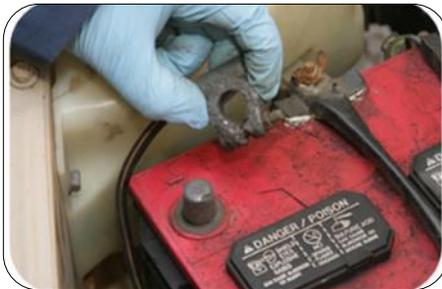
Utilisez des gants de sécurité, des bottes et des lunettes de sécurité lorsque vous changez/remplissez l'acide de la batterie et nettoyez les bornes. L'acide est corrosif et peut causer des brûlures à la peau et aux yeux.
