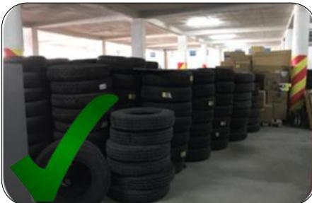
Entreposez les pneus sur une surface dure dans un endroit bien aéré et couvert pour éviter l'accumulation d'eau de pluie et la prolifération des moustiques.
