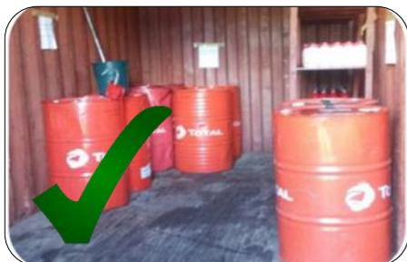
Les réservoirs de carburant hors d'usage en attente de recyclage devraient être entreposés à une distance sécuritaire des matériaux potentiellement inflammables, des sources d'étincelles et sur une surface dure protégée.
