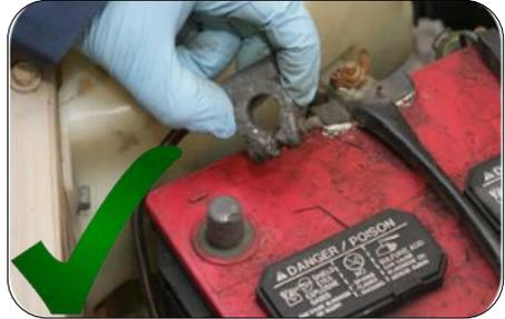
Utilisez l'équipement de protection individuelle (bottes, lunettes, gants de sécurité) pour remplir/remplacer l'acide de la batterie et nettoyer les bornes avec du bicarbonate de soude.
