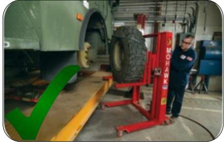
Utilisez l'équipement de protection individuelle approprié (bottes, lunettes, gants de sécurité) pour manipuler des pneus, en particulier les pneus pour forte charge.
