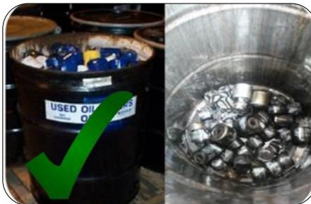
Vidangez l'huile des filtres dans un contenant et entreposer les filtres dans un fût étiqueté, sur une surface dure. Les filtres doivent être éliminés par un entrepreneur agréé.
