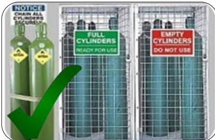
Entreposez les bouteilles d'oxygène et de gaz combustible séparément dans un endroit bien ventilé. Étiquetez toujours les cylindres et chaînez les ou sectorisez les de façon à ce qu'ils restent debout.
