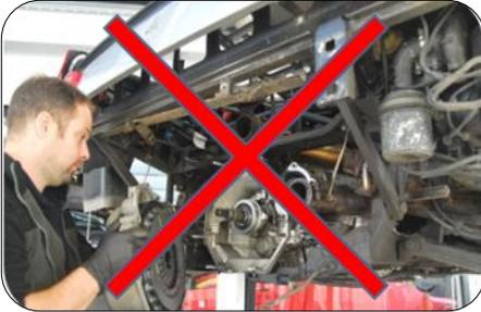
Ne manipulez pas les plaquettes de frein comme si elles étaient sans amiante. Il n'est pas possible de distinguer si un composant contient de l'amiante simplement en le regardant.
