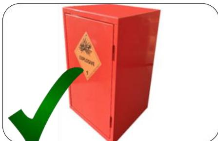
Lorsque de nouveaux airbags sont stockés dans l'atelier, utilisez une armoire à airbags ou un conteneur en acier qui n'a pas d'acier à nu, qui est facile à nettoyer et qui peut être fermé et verrouillé. Certains airbags sont classés comme explosifs.
