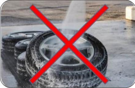
Évitez de laver les pneus lorsque cela n'est pas nécessaire. Le contact constant avec l'eau érode la bande de roulement. S'assurer que les eaux usées sont recueillies dans le système d'égout, la fosse septique ou l'équivalent.
