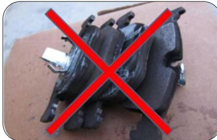
Ne rangez pas les plaquettes de frein neuves ou usagées sans protection ni étiquetage clair. N'oubliez pas que les plaquettes de frein peuvent contenir et libérer des fibres d'amiante. Ne les jetez pas sur le sol ou dans les cours d'eau non protégés.
