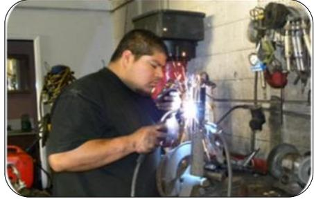
N'effectuez pas de soudure sans l'équipement en papier. Les fumées de soudage sont toxiques et l'exposition à long terme à l'arc de soudage endommage les yeux.
