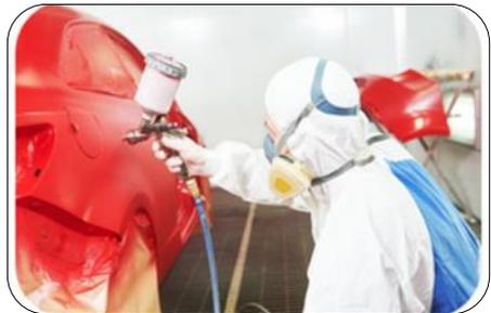
Utilisez des gants en PVC, des bottes de sécurité, une combinaison de protection avec capuchon et un respirateur purificateur d'air pour la peinture. Évitez l'exposition aux fumées toxiques.
