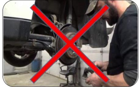
Ne travaillez pas sur les plaquettes de frein sans masque (au minimum) pour éviter l'exposition à l'amiante.
