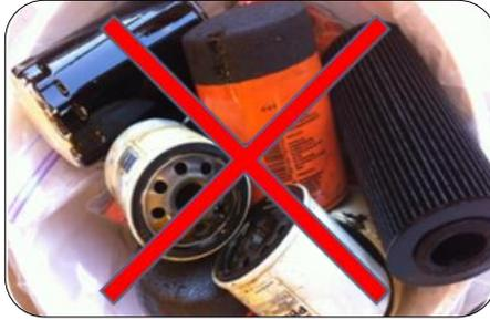
Ne mélangez pas des filtres métalliques avec des filtres en papier ou en carton. Rappelez-vous que les filtres métalliques peuvent être recyclés s'ils sont correctement drainés et que les filtres en papier peuvent être utilisés comme combustible dans des installations comme les cimenteries.
