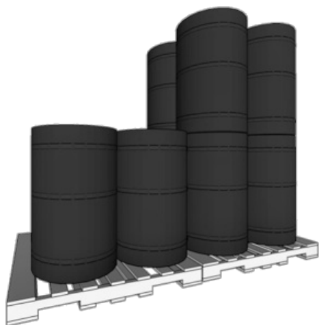
Cilindros armazenados na vertical
