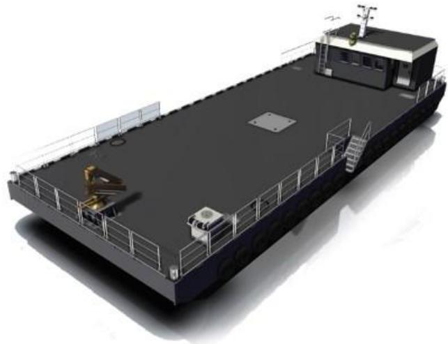
**صندل ثابت القاع** - هو منصة عائمة لا تعمل بالطاقة الذاتية، قادر على حمل البضائع، لكنها بدون توجيه أو محرك. يتطلب الصندل ثابت القاع قاربًا خارجيًا للتحرك، بما في ذلك زورق سحب أو "قارب دفع"، وهو قارب ذو دوافع منفصلة
