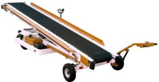
**عربة سحب جهاز تحميل الوحدة/ألواح تحميل الطائرة -** عربة سحب مصممة لحمل وحدات التحميل ومنصات الطائرات مسبقة الصنع. لا تُشغل عربات السحب من تلقاء نفسها، ويجب سحبها أو دفعها عبر المدرج. تساعد البكرات في التفريغ والتحميل، ولكن يجب دفع البضائع جسديًا حيث لا توجد عملية مدفوعة ميكانيكيًا.
