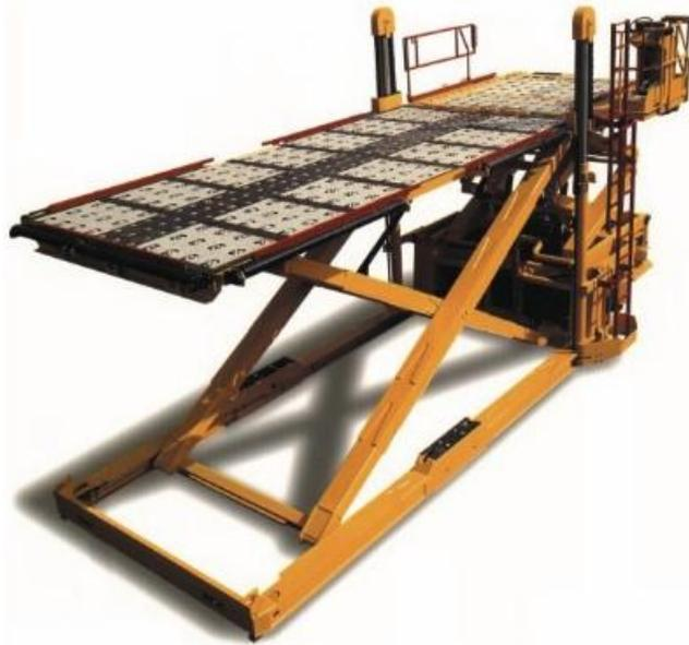
**ULD/deslocador de paletes em aeronave** -Um veículo especializado concebido para se deslocar em torno das ULD e das paletes de aeronaves sobredimensionadas numa pista ou em pistas de aterragem. Os transportadores de paletes têm rolos e outro equipamento para rapidamente colocar e retirar itens de carga, e trabalhar em conjunção com carregadores altos e outros MHE.
