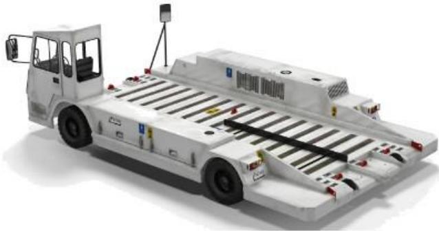
**Carregador de correia** - Uma correia transportadora automatizada com altura ajustável que pode transportar artigos mais pequenos para a porta de uma aeronave de qualquer tamanho. Os carregadores de correia são normalmente utilizados para bagagem, pacotes soltos ou pequenos artigos. Os carregadores de correia também podem ser utilizados para aeronaves demasiado pequenas para utilizar um carregador alto.
