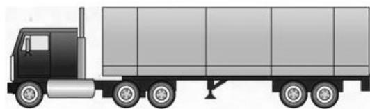
**侧帘/侧卸车身**——侧帘/侧卸车身克服了进出不便的缺陷；可通过向后拉帘或放下车厢侧板来露出整个车厢底板。这样可提高装卸速度。同时，车身重量低于箱体，从而兼顾了载荷限制和防风雨的优势。但是，侧帘/侧卸车身不太安全，货物比较容易被拿走且无法始终锁闭。
