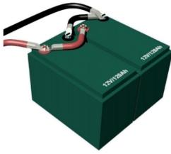
将电池并联在一起可让容量提高一倍，同时保持电压不变。并联是将多个电池的正极和负极相互连接。然后，将第一块电池的正极和最后一块电池的负极连接到系统。
