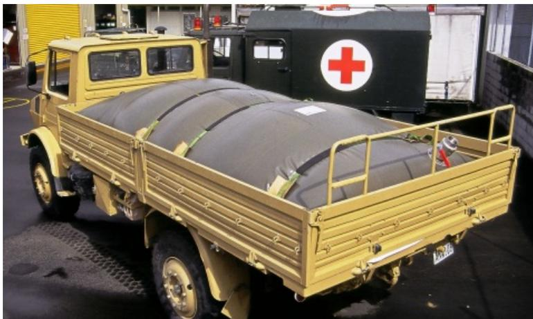
上车后的燃料囊应像所有其他货物一样得到适当的支撑和固定。捆扎装置需要承受燃料的全部重量，并且燃料囊本身也应有作为移动运输工具使用时的适当额定值。使用燃料囊运输之前，请咨询其制造商。
