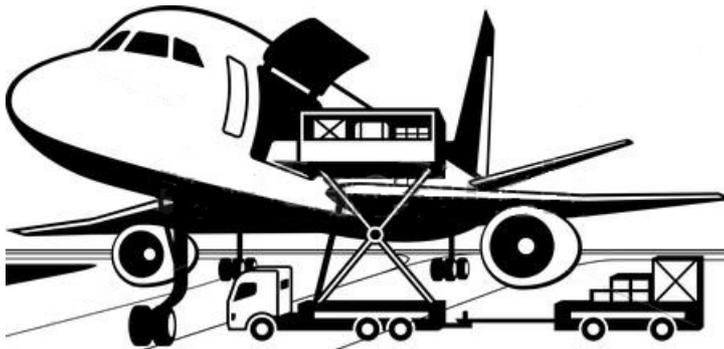
K 型装载机——在飞机旁装载货物时需要使用的高升降机。
