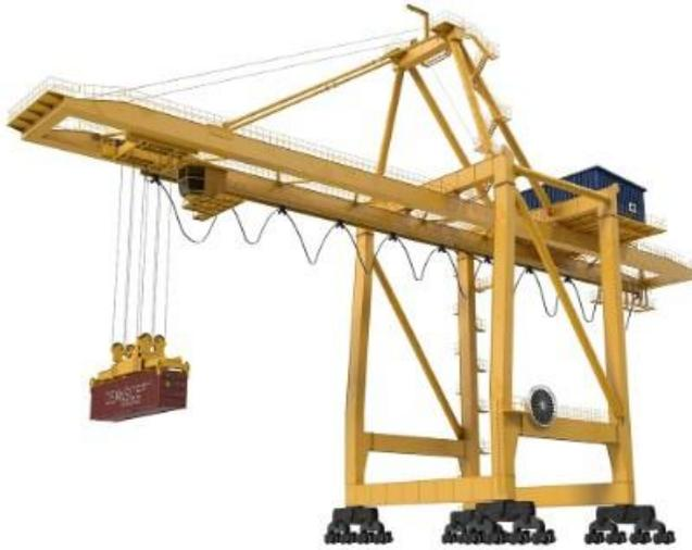
**龙门起重机**——另一种可移动的集装箱起重机，专门横跨船只或堆货两侧。龙门起重机的尺寸足以跨越整艘船的甲板，但也可用于装卸载卡车或货堆。
