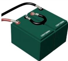
将电池串联在一起可提高电压，同时保持安时容量不变。在这种配置下，电池在串联后可获得更高的电压，例如 24 伏甚至 48 伏。每个电池的正极都连接到下一个电池的负极，而第一个电池的负极和最后一个电池的正极连接到系统。
