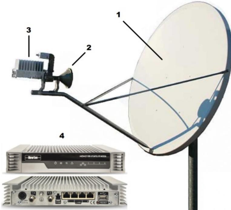
BUC、LNB 和调制解调器都需要外部供电，但电压通常相对较低。如果基地或办公室在一天或一周内会多次停电，但始终需要卫星互联网连接，则必须考虑为 VSAT 提供备用电池。此外，BUC 和 LNB 设备位于室外，容易接触。尽管其功率相对较低，用户应避免在有电时触摸或与之接触。如有必要，可在天线上标记警告信号，甚至安装栅栏以保证安全。
