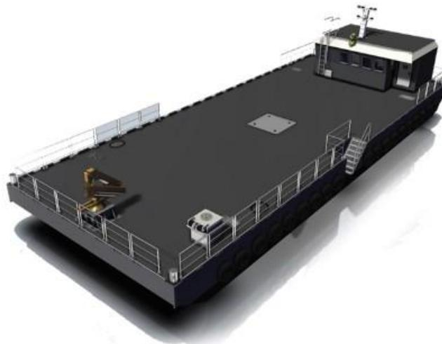
**صندل ثابت القاع** - هو منصة عائمة لا تعمل بالطاقة الذاتية، قادر على حمل البضائع، لكنها بدون توجيه أو محرك. يتطلب الصندل ثابت القاع قارباً خارجياً للتحريك، بما في ذلك زورق سحب أو "قارب دفع"، وهو قارب ذو دوافع منفصلة مصمم خصيصاً لدفع أو سحب صندل ثابت القاع على طول الممرات المائية.
