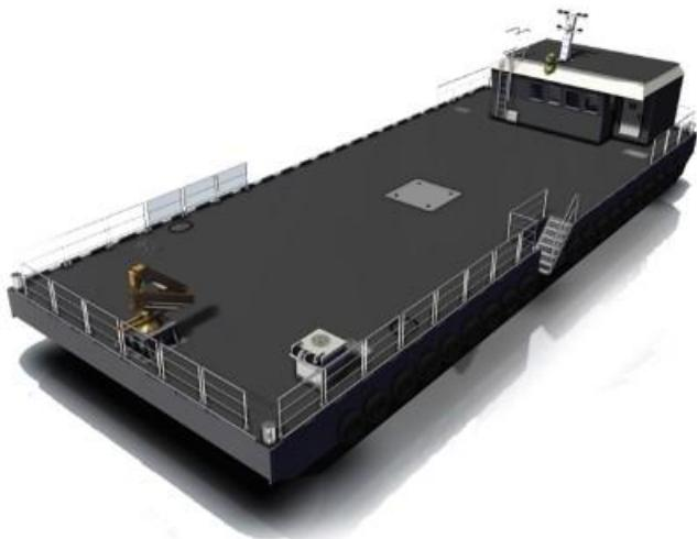
**Несамоходные** – несамоходные баржи представляет собой несамоходную плавучую платформу, способную перевозить груз, но не имеющую рулевого управления или двигателя. Для перемещения несамоходных барж требуется внешнее судно, в том числе буксир или «толкач» — отдельное моторное судно, специально разработанное для толкания или буксировки несамоходных барж по водным путям.
