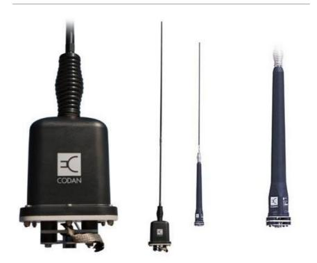
天线本身可能会引发安全问题。 使用无线电时,即使在很短的时间内也会有大量的电流流向天线。 人或 动物接触使用中的天线,可能会因此而遭受高温或电击伤害。 此外,天线鞭的高度使其很容易被树木、桥梁或悬挂在低处的材料或结构挂住,从而损坏结构、天线鞭或两者。
