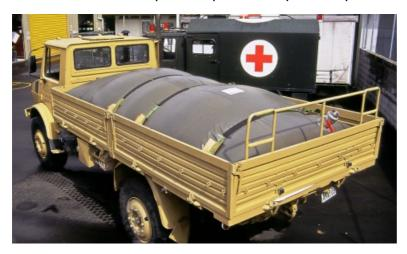
Les réservoirs souples de carburant transportés dans un véhicule doivent être correctement calés et sécurisés, comme toute autre charge. Les attaches doivent pouvoir supporter le poids total du carburant, et le réservoir souple lui-même doit être d'une qualité appropriée pour être utilisé comme récipient mobile de transport. Consultez le fabricant avant d'utiliser un réservoir souple à des fins de transport.
