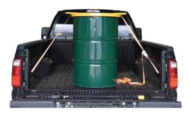
Les fûts pleins doivent dans l'idéal être transportés debout, sur leur bord plat, pour éviter qu'ils ne roulent pendant le transit. Évitez le double empilage de fûts pleins, à moins qu'il n'y ait des rambardes spéciales ou des mécanismes de sécurisation en place.
