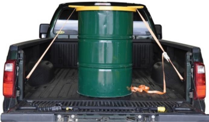
理想情况下，应沿其平边、以直立状态运输装满燃料的桶，以避免其在运输过程中滚动。除非有专门的栏杆或固定装置，否则应避免双层堆放装满燃料的桶。
