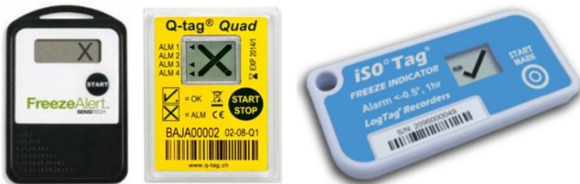
**Indicadores electrónicos de transporte.** Dispositivos más sofisticados que muestran si un producto ha estado expuesto a temperaturas superiores a las asignadas en la configuración de la alarma. Registran la temperatura a intervalos periódicos durante un cierto período (normalmente no más de 20 días debido al desbordamiento de la memoria). Tienen una pantalla digital que refleja si el producto transportado ha superado los umbrales de la alarma.
