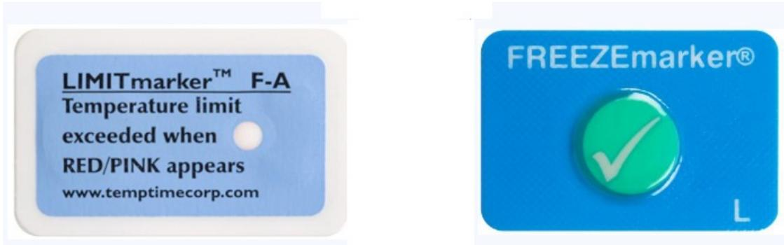
Os indicadores químicos de *tipo progressivo* registam múltiplos eventos de uma forma cumulativa. Sempre que a temperatura limite é ultrapassada, a reação é ativada e o indicador começa a mudar. Outras violações de temperatura aumentam o processo de mudança. O indicador para este tipo de dispositivo toma geralmente a forma de uma mudança progressiva de cor ao longo de uma tira de papel.
