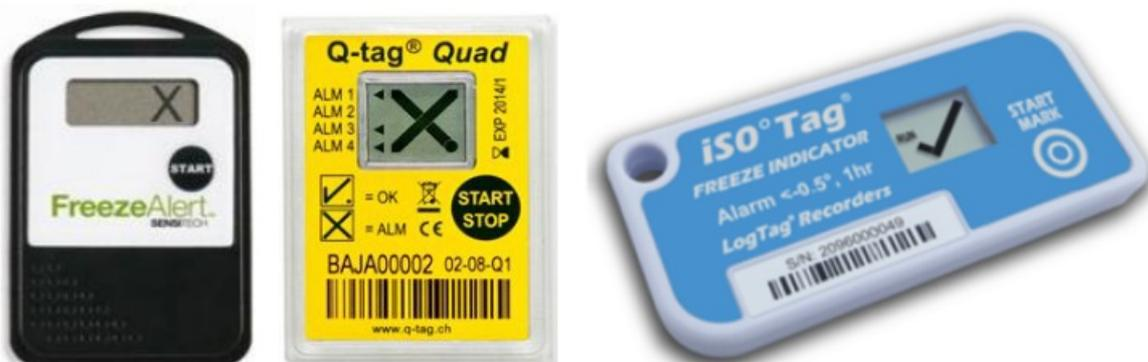
**Электронные индикаторы транспортировки** – более сложные устройства, которые показывают, подвергался ли продукт воздействию температур, выходящих за пределы установленных настроек сигнализации. Они регистрируют температуру через равные
