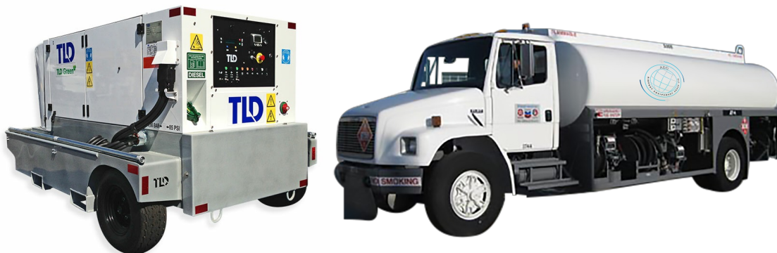
Unidad de alimentación en tierra (GPU) Camión de reabastecimiento en zona de operaciones
