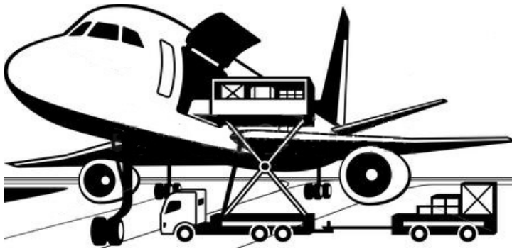
Pala cargadora de tipo K - Cuando la carga requiere una manipulación a gran altura junto al avión
