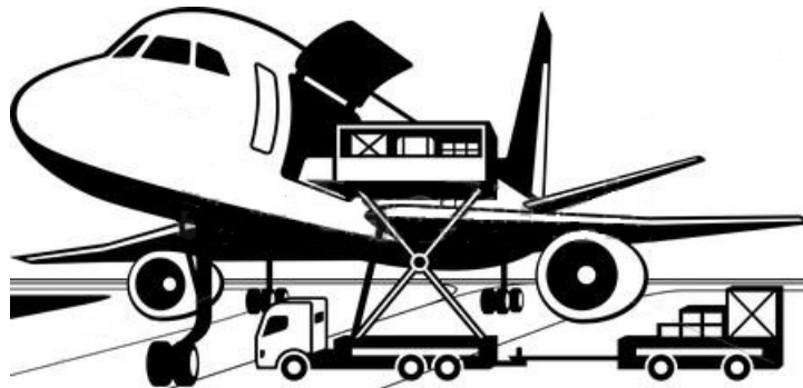
Chargeur K - Cargaison nécessitant un chargement à haute levée le long d'un aéronef
