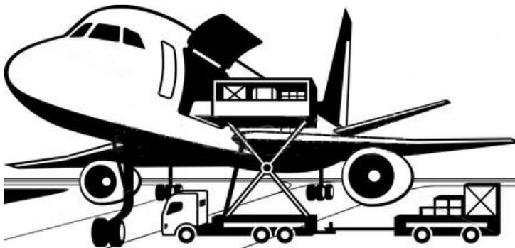
K-loader - Carga que requer alta carga de elevador alto, pela lateral de uma aeronave
