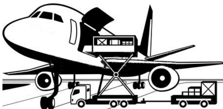
K-loader - Carga que requer alta carga de elevador alto, pela lateral de uma aeronave
