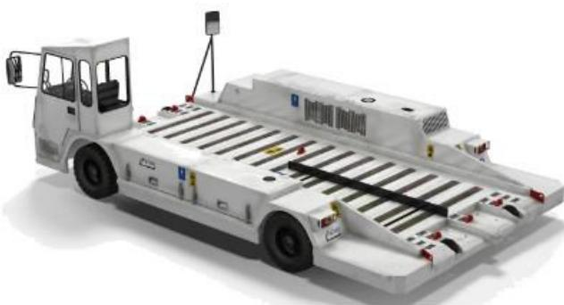
**Ленточный погрузчик** – автоматизированная конвейерная лента с регулируемой высотой, которая может транспортировать мелкие предметы к двери воздушного судна любого размера. Ленточные погрузчики, как правило, используются для перевозки багажа, незакрепленных единиц упаковки или небольших специальных предметов. Ленточные погрузчики также могут использоваться для воздушных судов, которые слишком малы для того, чтобы принимать погрузчик с высоко расположенной платформой.
