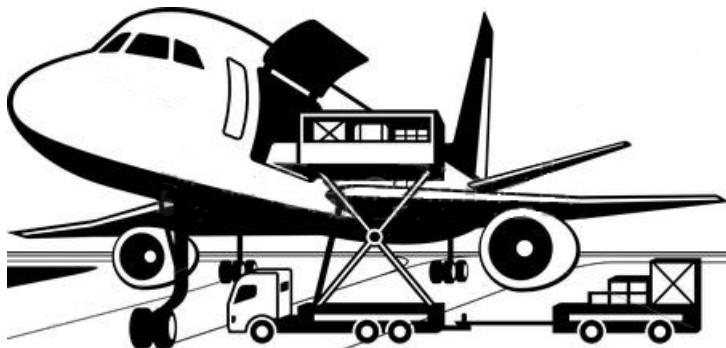
Погрузчик типа К (пантограф) – предназначен для груза, требующего высокой подъемной нагрузки рядом с воздушным судном.
