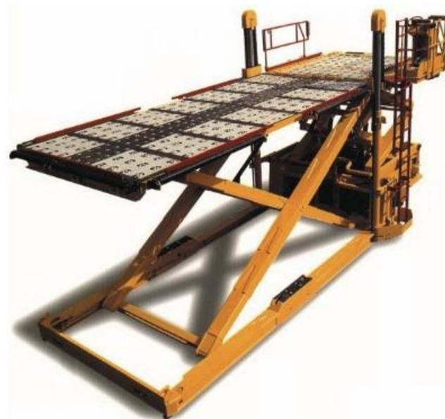
**集装设备/空运托盘搬运机**——一种专为在停机坪或跑道上移动超大尺寸集装设备和空运托盘而设计的特种车辆。托盘搬运机配有关节和其他设备，可以快速装卸货物，并可与强光灯和其他物料搬运设备搭配使用。
