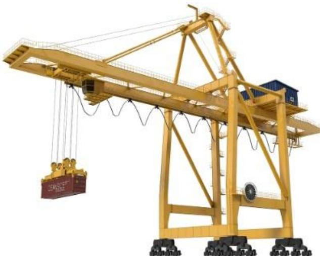
**龙门起重机**——另一种可移动的集装箱起重机，专门横跨船只或堆货两侧。 龙门起重机的尺寸足以跨越整艘船的甲板，但也可用于装卸载卡车或货堆。
