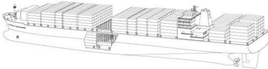
尽管有数十种集装箱类型，可满足多种需求，但绝大多数集装箱都是 20 英尺 (TEU) 或 40 英尺 (FEU) 的“干货集装箱”。TEU 和 FEU 集装箱完全封闭，虽然称为“干货”，但实际上并未达到气密封。集装箱本身可上锁和堆叠，且两个 TEU 可以码放在一个 FEU 的顶部或下方。标准干货集装箱主要是钢制，但也有铝制的。
