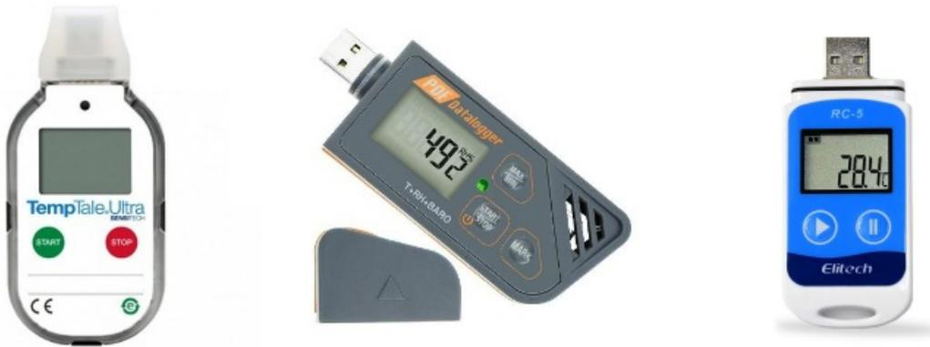
Une fois activés, les enregistreurs de données de température peuvent être déposés dans une boîte ou un colis d'articles de santé et récupérés à l'autre extrémité. Les enregistreurs de données de température peuvent donc être utilisés lors de l'expédition de boîtes individuelles, de palettes ou de grands volumes d'articles, ainsi que lorsque l'expédition fait intervenir plusieurs transporteurs ou implique plusieurs modes de transport.
