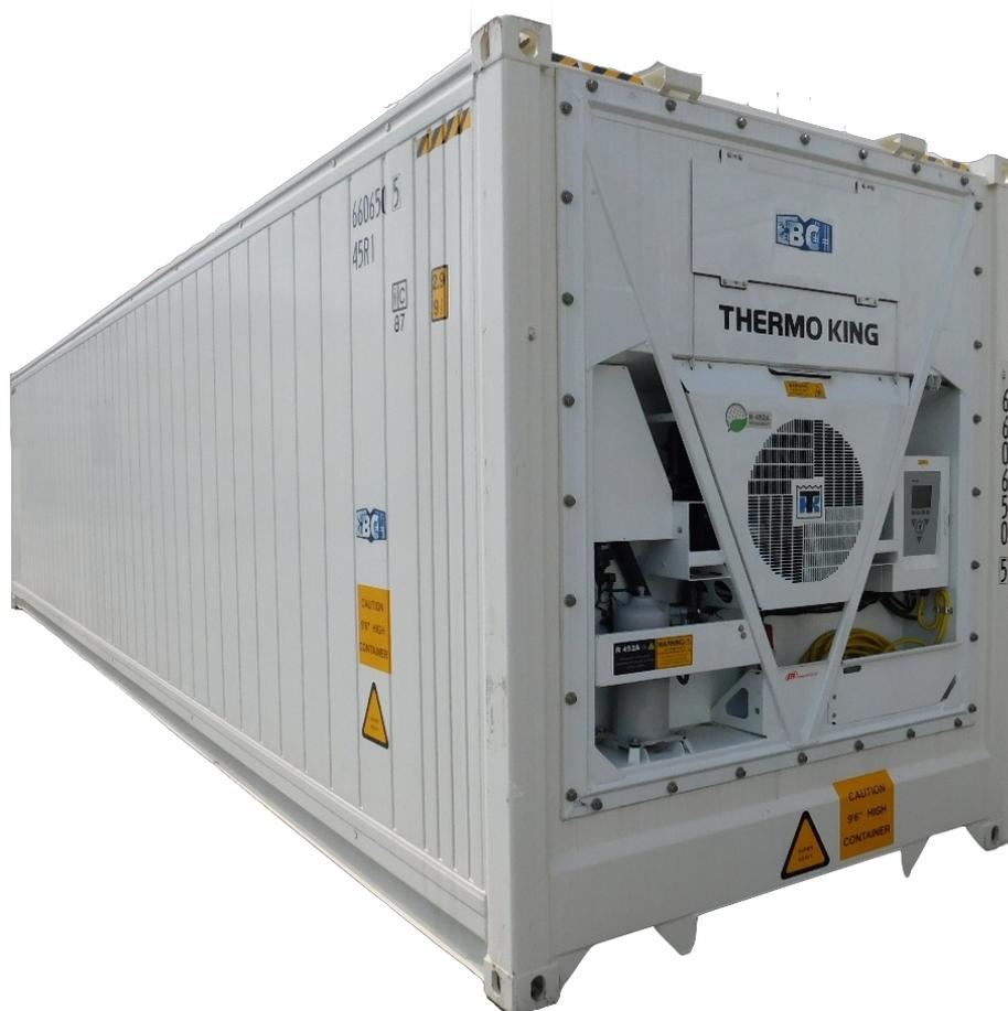
所有用于海运的冷藏集装箱都必须经过所谓的装箱前检查 (PTI)。除非冷藏集装箱为货物发运人所有，否则由船运公司负责进行 PTI。PTI 对集装箱、制冷设备和监测设备的状况进行验证，根据航运公司的需求
