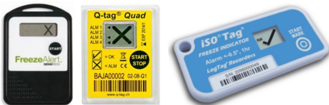
电子运输指示器 - 更为复杂的设备，用于显示产品是否曾暴露在超出指定警报设置的温度下。它们在一定时间段内定期记录温度（由于内存溢出，通常不超过 20 天）。它们有一个数字显示屏，可以反映出运输的用品是否曾超过了警报阈值。
